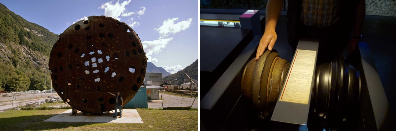
Links: Originaler Bohrkopf (ohne Schneidrollen) mit Johann THUT als Maßstab einer TBM am Informationszentrum in Bodio.
